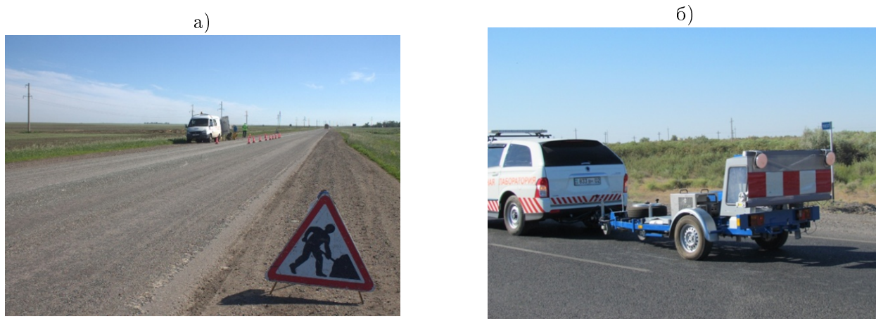
Рис. 1: Общий вид обследуемого участка (а); процесс измерения модуля упругости дорожной одежды дефлектометром (б)
